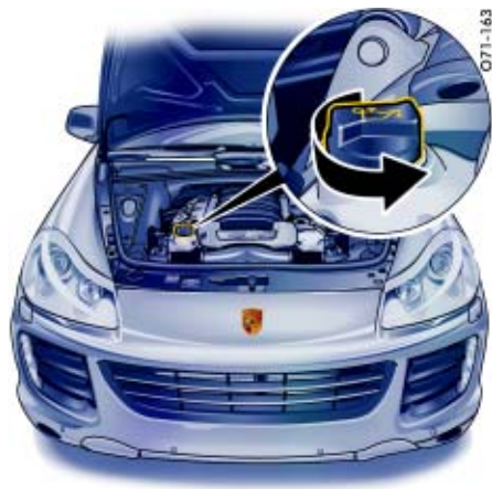
Cayenne S、Cayenne GTS 上的机油加注点
