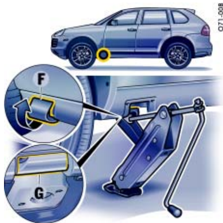
带有车门槛护板的车辆 前部举升点
