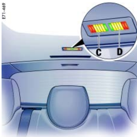
C - 后部显示 - 右侧监控区域 D - 后部显示 - 左侧监控区域
