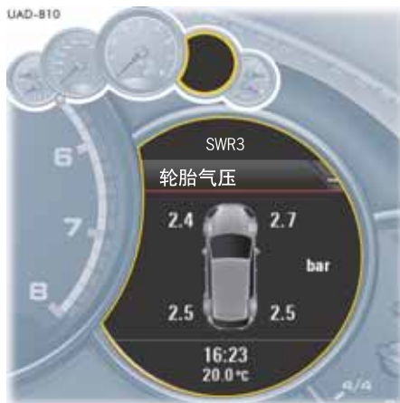
多功能显示器上的轮胎气压显示
