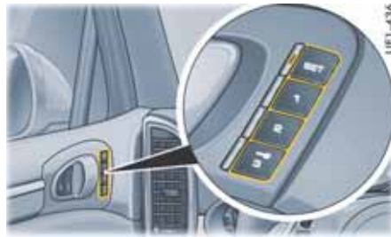
手动在驾驶员侧车门中的按钮上存储设置
