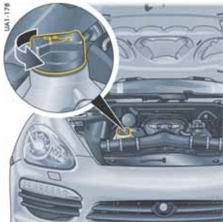
V8 发动机上的机油加注点
