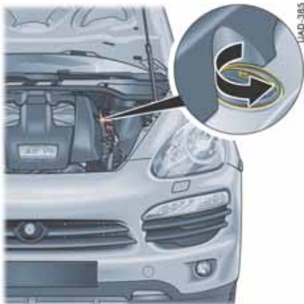
V6 发动机上的机油加注点
