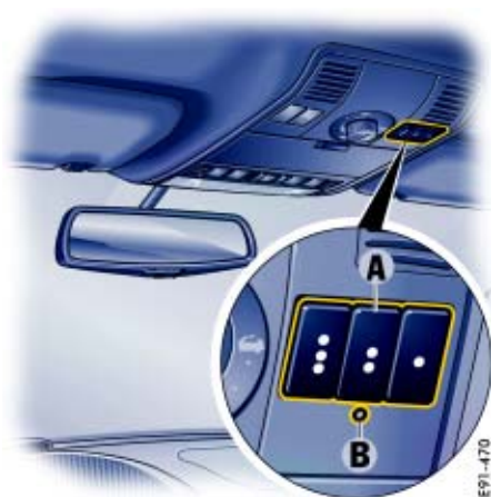
A - 可编程数字键盘 B - 状态识别发光二极管
